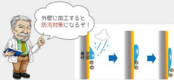
プラチナコーティングを施工した外壁は、紫外線による分解効果に加え雨水がかかると雨水は水滴にならず水の膜（親水効果）になり、汚れの下に水が溜り込みます。
